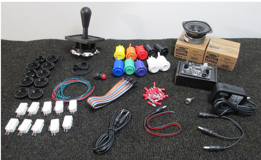
Fotografia 3. Podzespoły elektryczne i elektroniczne, potrzebne do wykonania automatu
