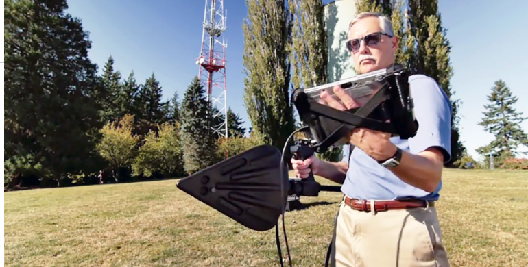
Fotografia 1. Przykładowe zastosowanie RSA500 przy poszukiwaniu interferencji. Na zdjęciu z opisywanym tabletem i anteną kierunkową
