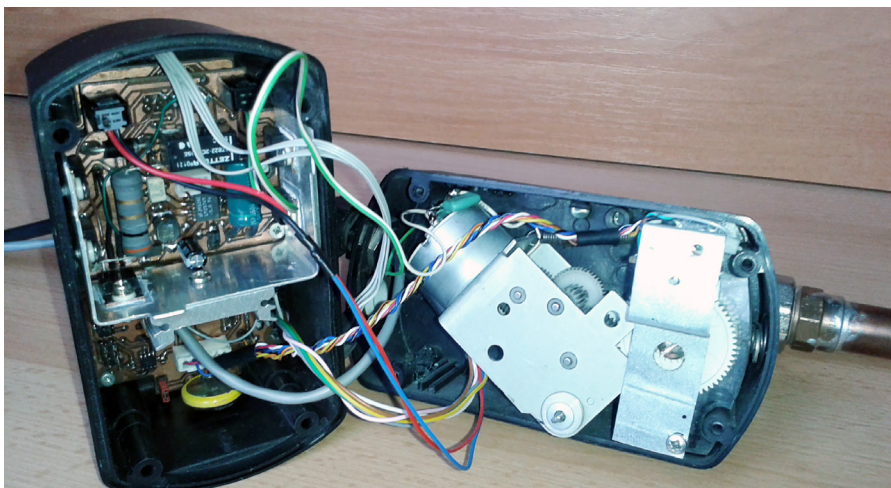
Fotografia 1. Części składowe nastawnika zaworu: elektronika sterująca i mechanizm
