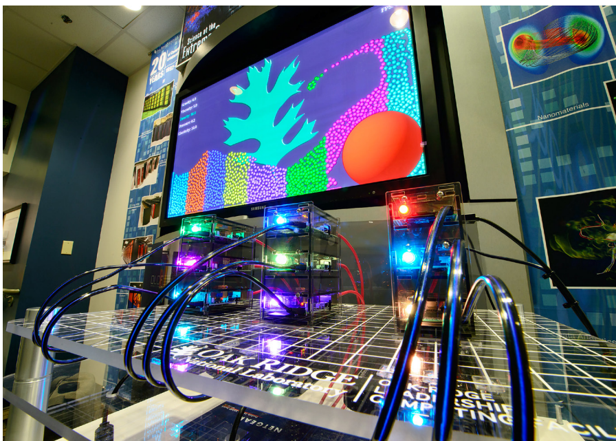
Fotografia 9. Tiny Titan to 9-elementowy superkomputer z Raspberry PI, przygotowany na potrzeby nauczania programowania superkomputerów
