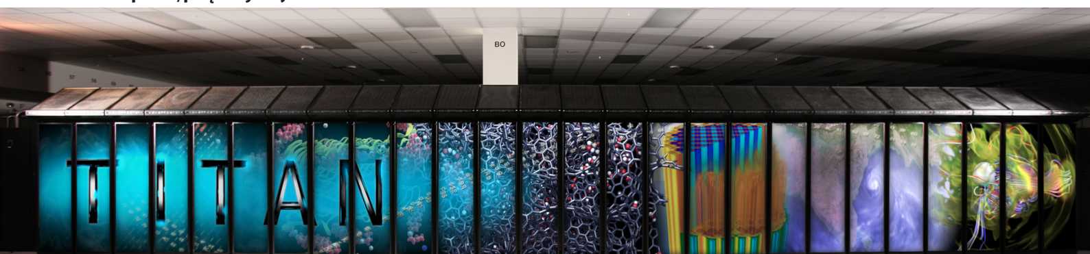
Fotografia 11. Superkomputer Titan, zbudowany przez firmę Cray i zainstalowany w Oak Ridge National Laboratory, złożony z procesorów AMD Opteron, połączonych z jednostkami GPU Nvidia Tesla
