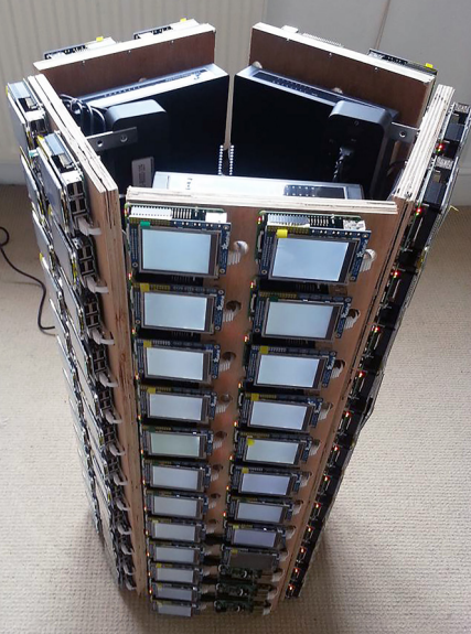
Fotografia 10. Superkomputer złożony ze 120 Raspberry PI, wyposażony w łącznie 120 modułów z wyświetlaczami
