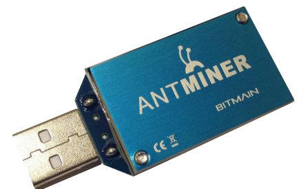
Fotografia 3. AntMiner U1, w którym użyto układ BM1380
