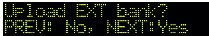
Rysunek 23. Wygląd ekranu interfejsu użytkownika DSPfactory w trybie aktualizacji banku danych External
