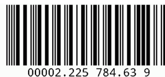
Rysunek 30. Treść „000022578463” zakodowana w postaci kodu Leitcode
