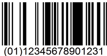
Rysunek 44. Treść „(01)123456789012” zakodowana w postaci kodu GS1 DataBar
