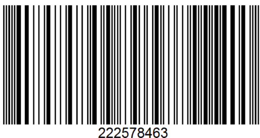
Rysunek 40. Treść „222578463” zakodowana w postaci kodu Telepen
