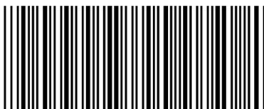
Rysunek 37. Treść „222578463” zakodowana w postaci kodu Code 32
