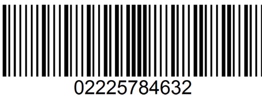
Rysunek 39. Treść „0222578463” zakodowana w postaci kodu MSI
