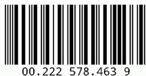
Rysunek 29. Treść „00222578463” zakodowana w postaci kodu Identcode
