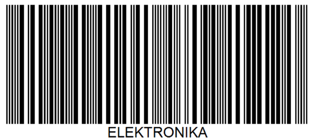
Rysunek 41. Treść „ELEKTRONIKA” zakodowana w postaci kodu Telepen
