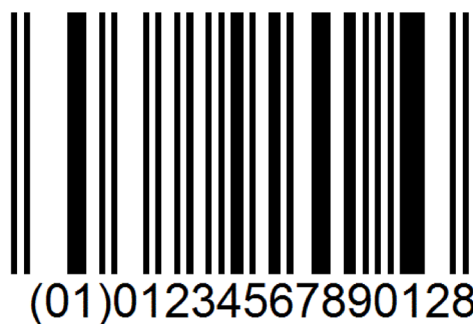
Rysunek 47. Treść „(01)0123456789012” zakodowana w postaci kodu GS1 DataBar Limited
