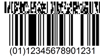
Rysunek 50. Treść „1234567890123|ELEKTRONIKA PRAKTYCZNA” zakodowana w postaci kodu GS1 DataBar Composite
