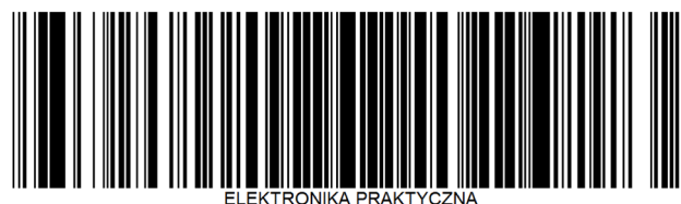
Rysunek 48. Treść „ELEKTRONIKA PRAKTYCZNA” zakodowana w postaci kodu GS1 DataBar Expanded
