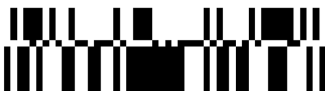
Rysunek 45. Treść „1234567890123” zakodowana w postaci kodu GS1 DataBar Stacked
