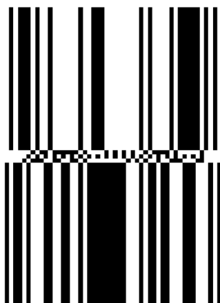
Rysunek 46. Treść „1234567890123” zakodowana w postaci kodu GS1 DataBar Stacked Omnidirectional
