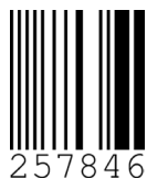
Rysunek 43. Treść „257846” zakodowana w postaci kodu Channel Code
