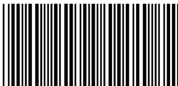
Rysunek 36. Treść „222578463” zakodowana w postaci kodu Pharmacode Two Track
