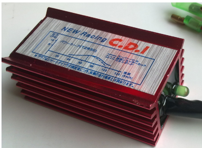
Fotografia 2. Zastosowanie obudowy jako radiatora w przykładowym module zasilającym
