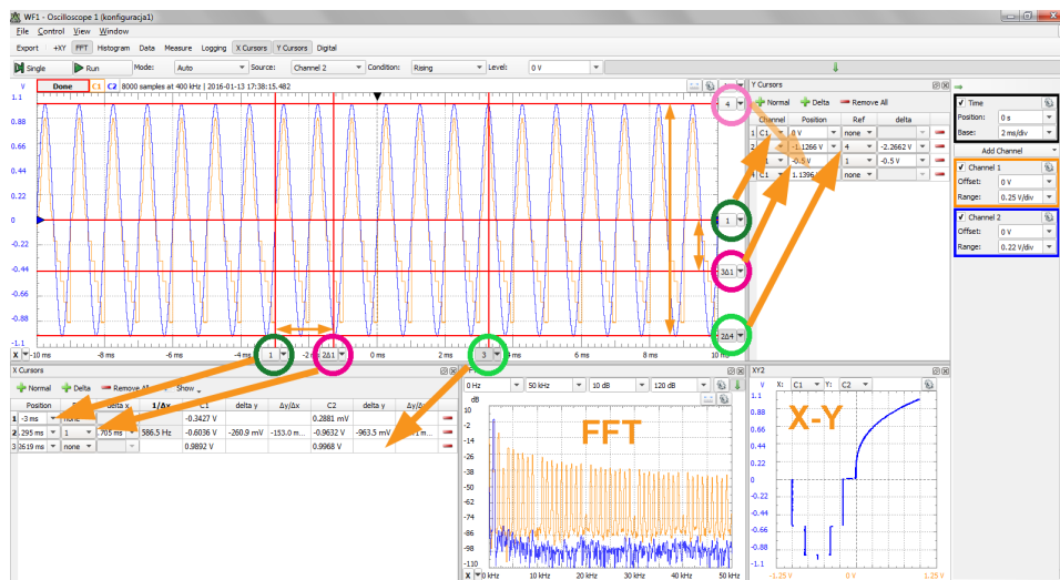
Rysunek 5. Kursory ekranowe oscyloskopu
