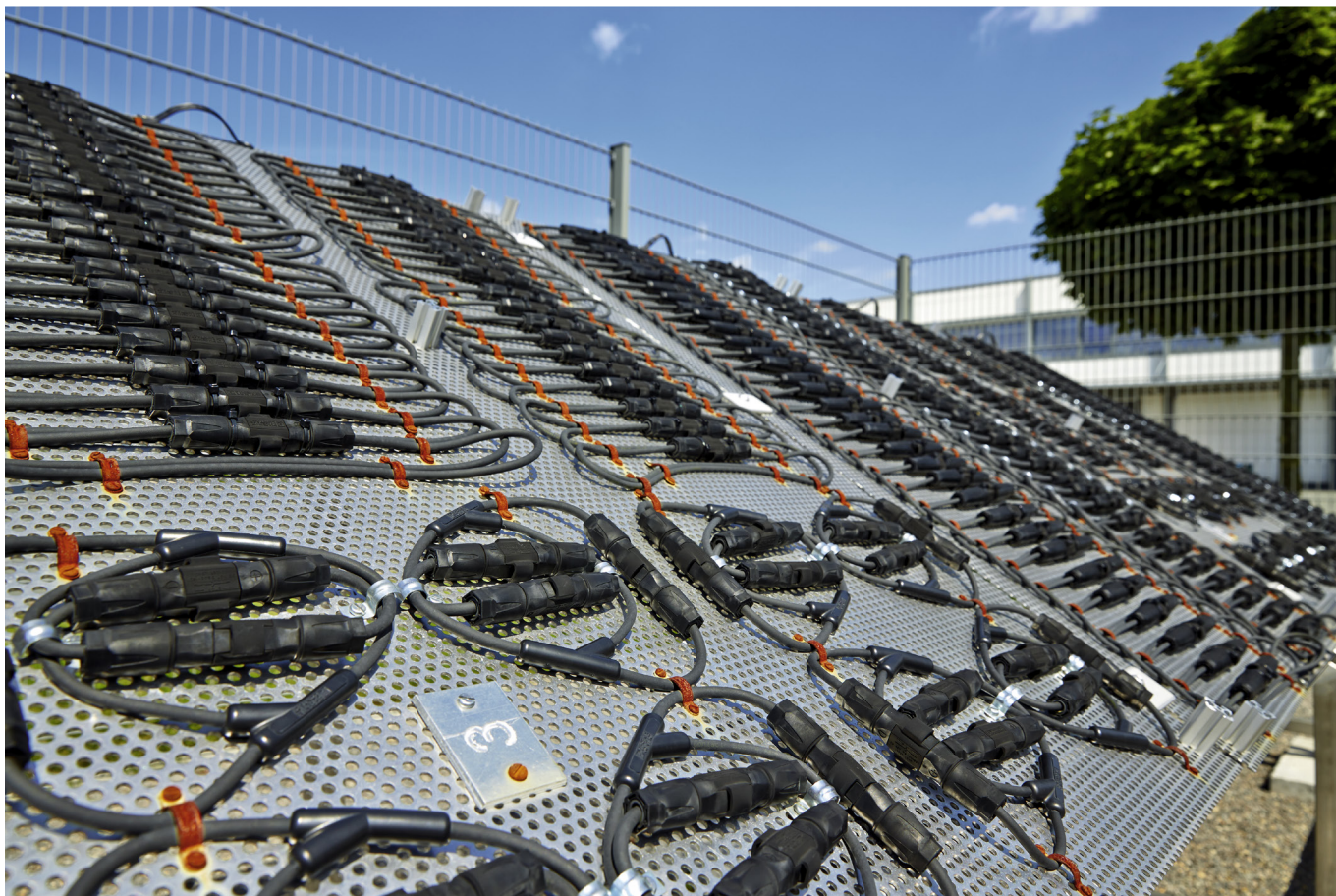
Fotografia 3. Producenci systemów złącz testują swoje rozwiązania, aby zapewnić bezawaryjną pracę w długim czasie funkcjonowania aplikacji
