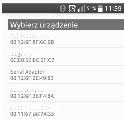
Rysunek 7. Ekran aplikacji sterującej pojazdem – nawiązywanie połączenia
