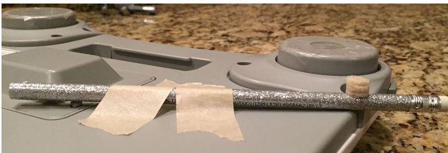
Fotografia 3. Autor wykonał dźwignię z ołówka, by ułatwić sobie naciskanie przycisku na spodzie Wii Balance Board
