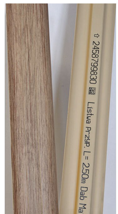
Fotografia 3. Znakowanie długich produktów w technologii CIJ
