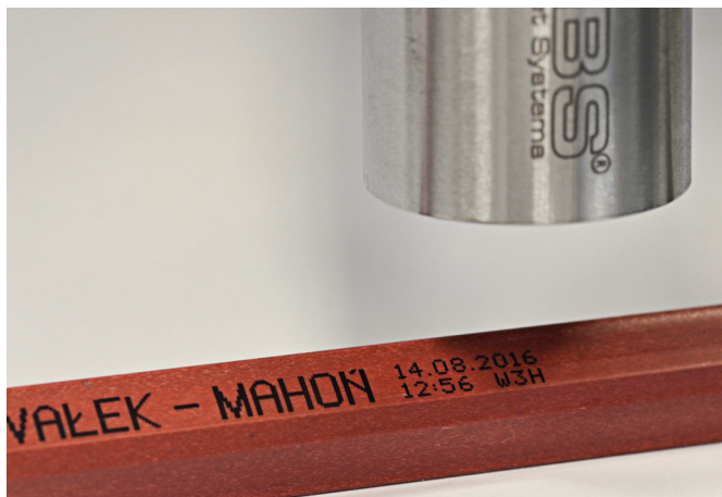
Fotografia 1. Odległość głowicy od znakowanego przedmiotu nawet do 3 centymetrów.
