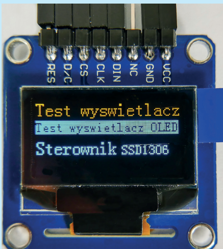
Fotografia 12. Wyświetlanie testowych napisów o wysokości 16 i 12 pikseli
