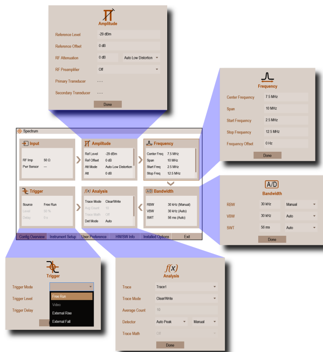
Rysunek 4. Okno Setup->Config Overview wykorzystywane do szybkiego konfigurowania analizatora
