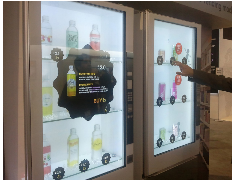
Fotografia 23. Przezroczysty ekran LCD, zastosowany na automacie do sprzedaży napojów
