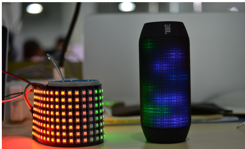
Fotografia 18. LEDy zamontowane na elastycznym podłożu pozwalają na tworzenie wygiętych ekranów
