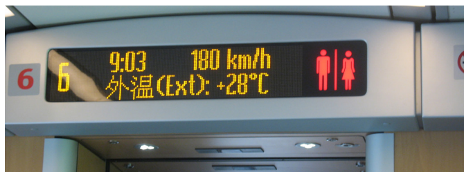
Fotografia 12. Ekran diodowy użyty do prezentowania informacji o aktualnej prędkości i czasie w chińskich kolejach.
