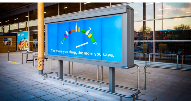
Fotografia 4. Ekran ciekłokrystaliczne połączone w szereg, stosowane jako panele informacyjne na lotnisku, pracujące na otwartym powietrzu. Warto zwrócić uwagę na niezwykle wąskie ramki poszczególnych ekranów
