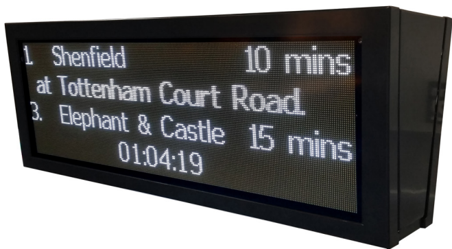
Fotografia 11. Matryca diodowa użyta do prezentacji informacji o zbliżających się pojazdach
