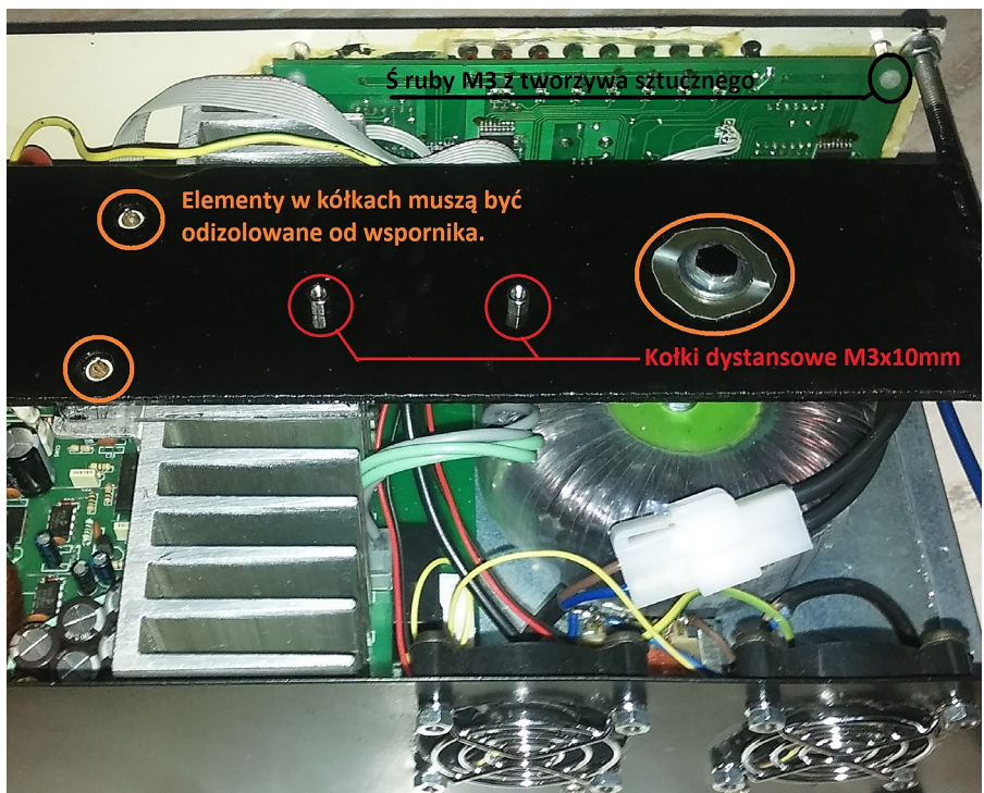
Fotografia 12. Na pomarańczowo oznaczono miejsca, w których śruby należy odizolować od obudowy
