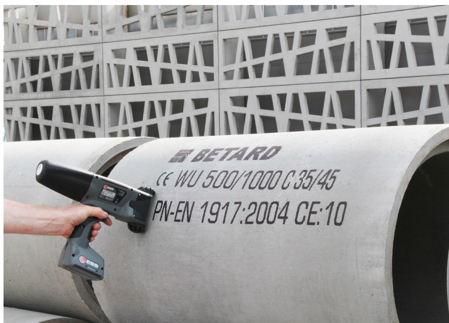
Fotografia 3. Wykonywanie nadruku na betonowych rurach kanalizacyjnych
