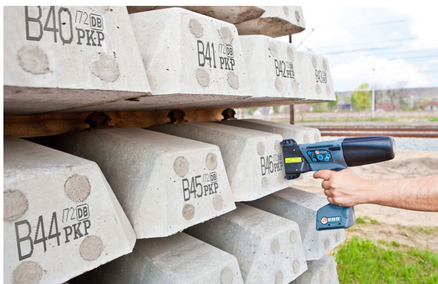
Fotografia 5. Wykonanie nadruku wieloliniowego na betonowych podkładach kolejowych
