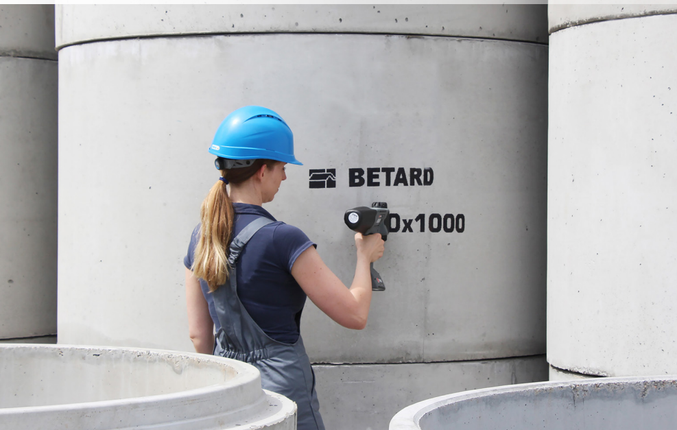
Fotografia 1. Wykonywanie nadruku na betonowych kręgach ułożonych w stopy
