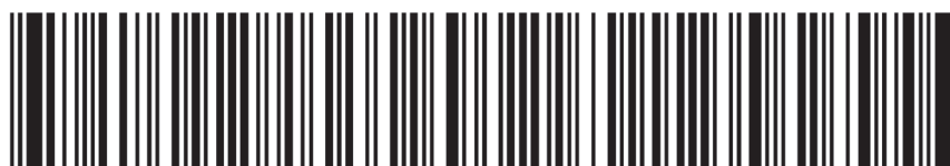
Rysunek 15. Treść „ELEKTRONIKA PRAKTYCZNA” zakodowana w postaci kodu Code 93
