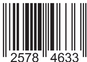
Rysunek 6. Treść „2578463” zakodowana w postaci kodu EAN-8
