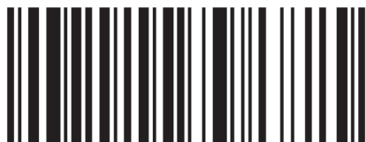
Rysunek 20. Treść „222578463” zakodowana w postaci kodu GS1-128
