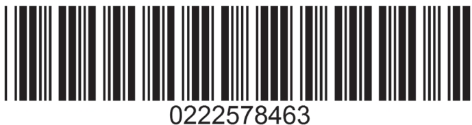
Rysunek 12. Treść „0222578463” zakodowana w postaci kodu Code 39
