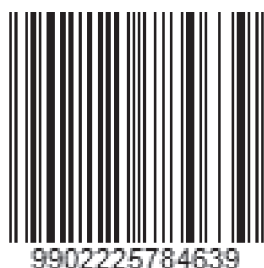
Rysunek 7. Treść „990222578463” zakodowana w postaci kodu EAN-99
