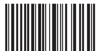
Rysunek 19. Treść „0222578463” zakodowana w postaci kodu Code 128 Mode C
