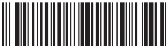
Rysunek 21. Treść „(22)2578463” zakodowana w postaci kodu GS1-128
