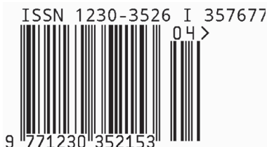
Rysunek 9. Treść „9771230352153:04” zakodowana w postaci kodu ISSN + 2
