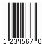
Rysunek 4. Treść „12345670” zakodowana w postaci kodu UPC-E
