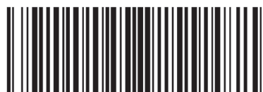
Rysunek 18. Treść „0222578463” zakodowana w postaci kodu Code 128 Mode A
