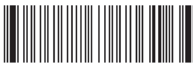
Rysunek 16. Treść „0222578463” zakodowana w postaci kodu Code 93
