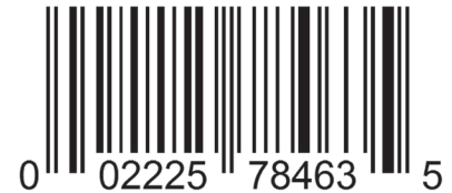
Rysunek 1. Treść „00222578463” zakodowana w postaci kodu UPC-A
