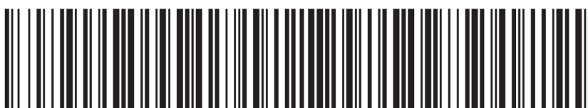
Rysunek 17. Treść „ELEKTRONIKA PRAKTYCZNA” zakodowana w postaci kodu Code 128
