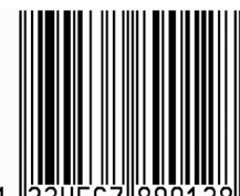
Rysunek 5. Treść „1234567890128” zakodowana w postaci kodu EAN-13
