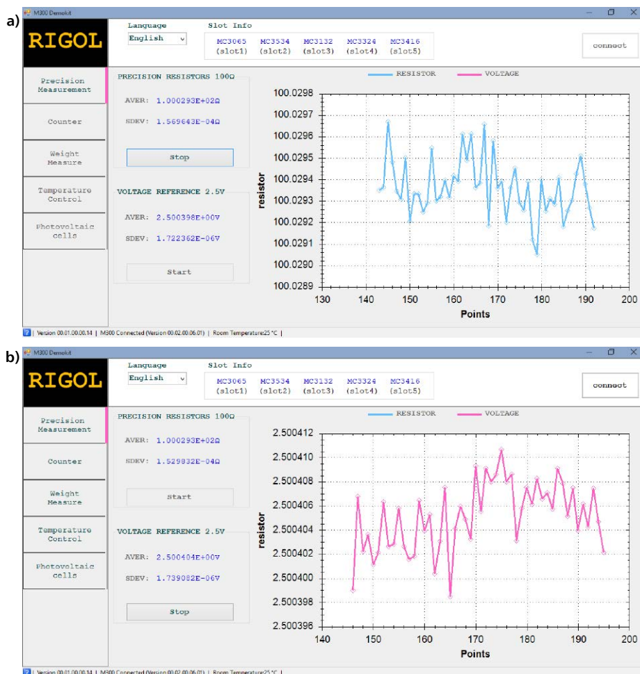
Rysunek 2. Precyzyjne pomiary z zastosowaniem M300 a) rezystancji 100 \Omega , b) napięcia 2,5 V
