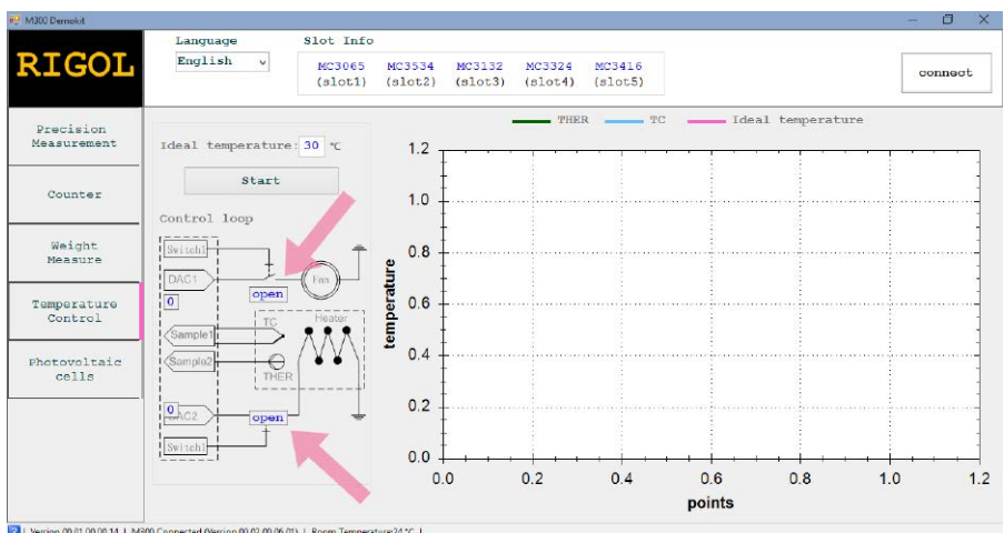
Rysunek 5. Regulacja temperatury – stan początkowy tuż przed rozpoczęciem pomiaru
