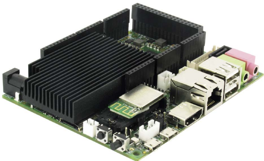
Fotografia 3. UDOO jest płytką wyposażoną w 2- lub 4-rdzeniowy procesor z rdzeniem Cortex-A9
