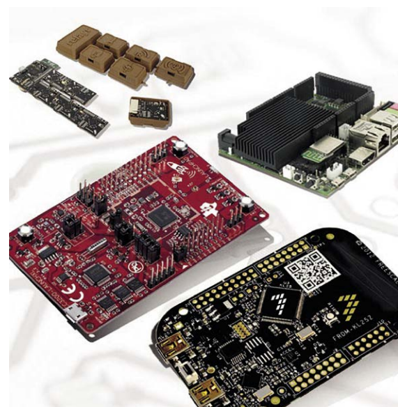
Fotografia 1. Oferta zestawów rozwojowych w Conrad obejmuje między innymi WunderBar od relayr (u góry po lewej), platformę rozwojową Freescale Freedom (prawy dolny róg), Texas Instruments SimpleLink WiFi CC3200 LaunchPad (w środku z lewej) i płytkę prototypową UD00 (prawy górny róg)
