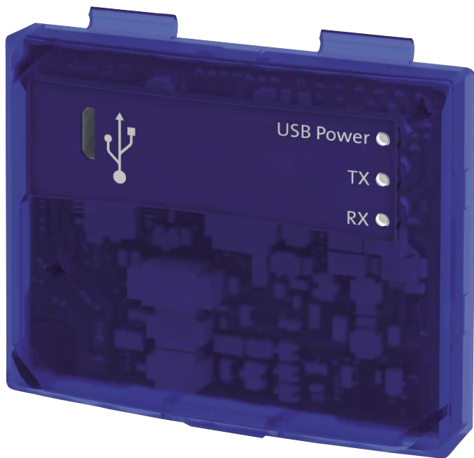
Fotografia 4. Do połączenia przemiennika z komputerem wystarczy moduł oraz zwykły przewód USB
