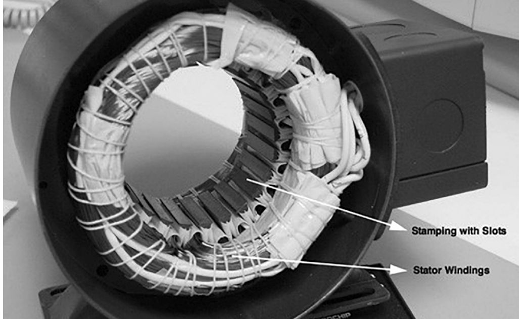
Fotografia 3. Stator silnika BLDC (źródło: nota aplikacyjna AN885 firmy Microchip)
