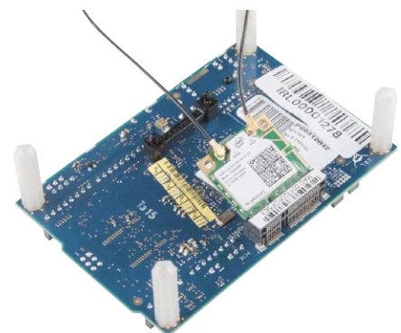
Fotografia 7. Intel Galileo z kartą Wi-Fi
