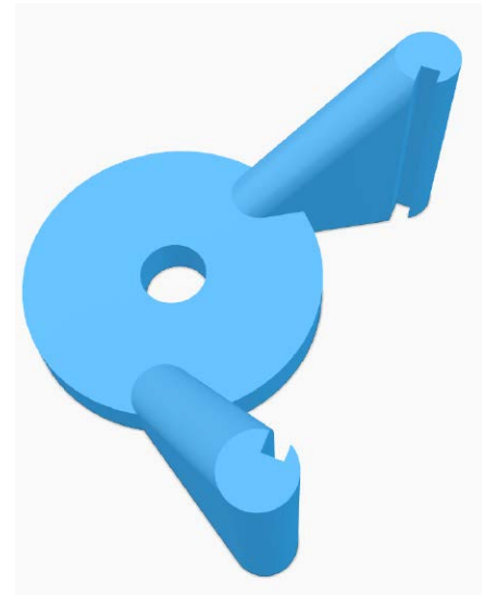
Rysunek 3. Model uchwytu kamery, drukowany na drukarce 3D
