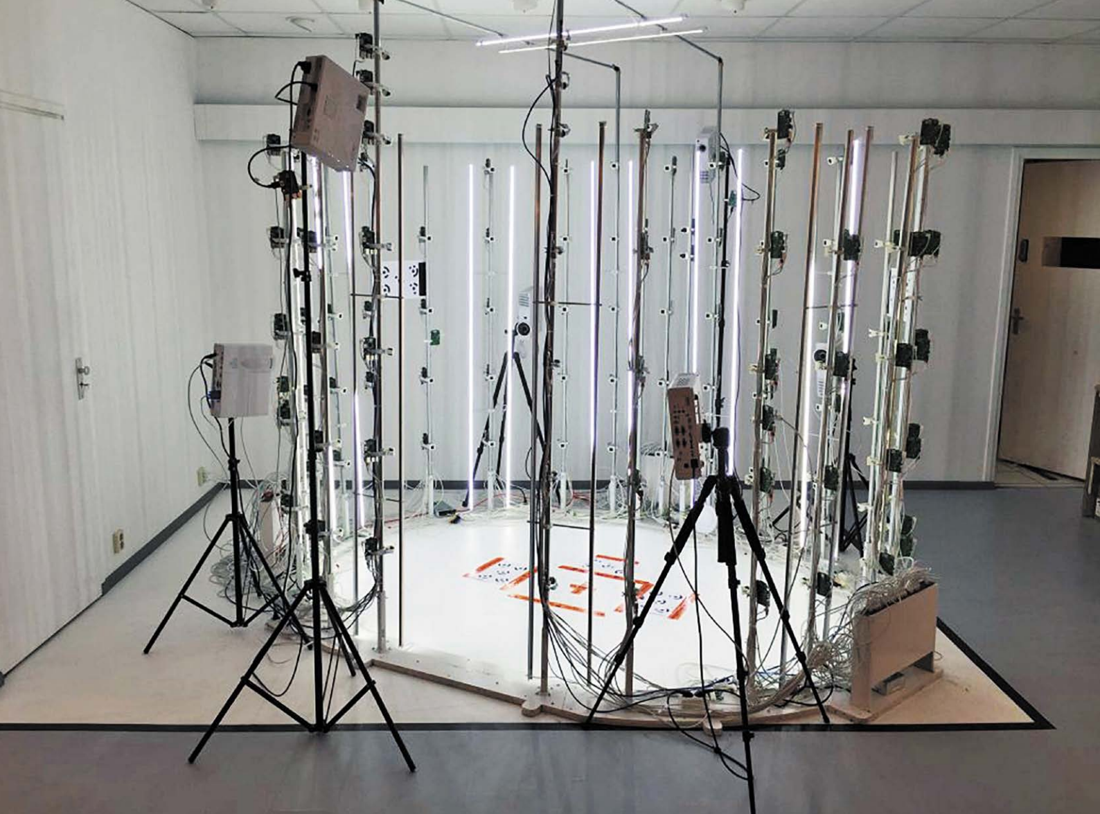
Fotografia 6. Gotowy skaner z 115 kamerami oraz dodatkowymi 6 rzutnikami, które wyświetlają siatkę na fotografowanym obiekcie
