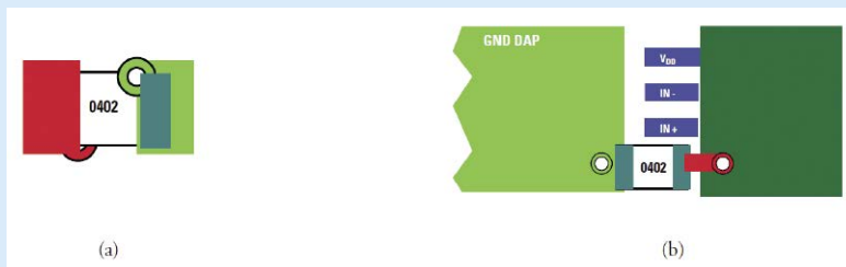
Rysunek 7. Typowy sposób umieszczenia kondensatora odsprzęgającego
