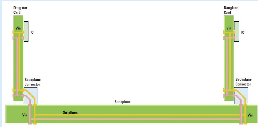
Rysunek 4. Uproszczony schemat podsystemu płyty tylnej
