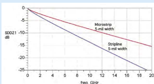
Rysunek 2. Straty 10-calowych sprzężonych mikropasków i linii paskowych wykonanych w materiale Nelco4000-6
