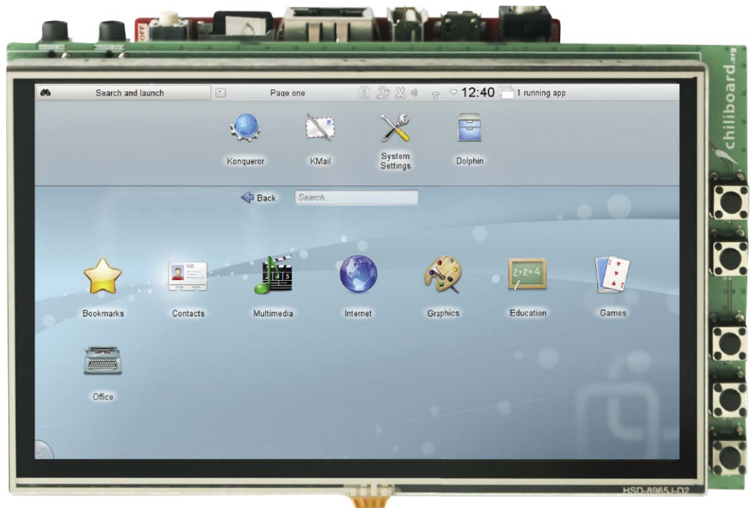
Fotografia 4. Pierwszy opracowany moduł z 5-calowym wyświetlaczem Riverdi o rozdzielczości 800×480 pikseli
