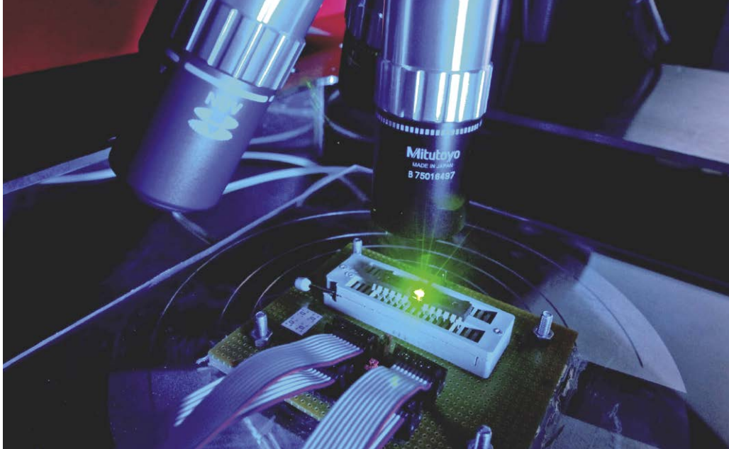
Fotografia 3. Próba manipulowania zawartością pamięci Flash za pomocą lasera (źródło: materiały firmy Fraunhofer)
