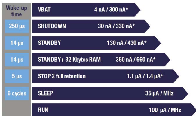
Rysunek 2. Oficjalne wykresy ilustrujące pobór prądu przez mikrokontroler STM32L4
