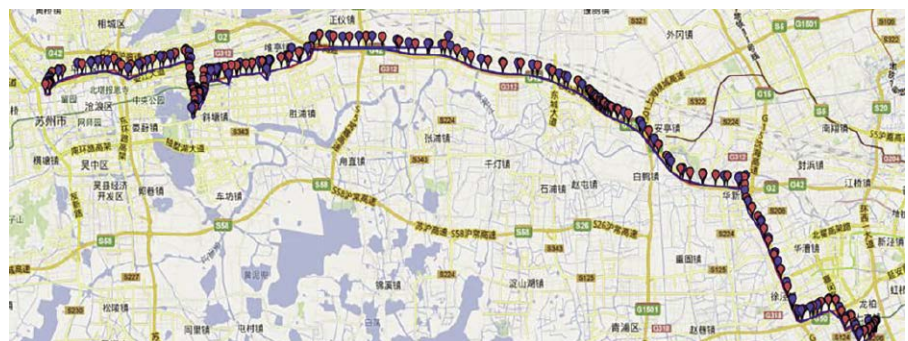
Rysunek 2. Przykład użycia bezpłatnej usługi QuecLocator, działającej niezależnie od nawigacji satelitarnej. Punkty zaznaczone niebieskimi markerami zostały wyznaczone za pomocą usługi QuecLocator, a punkty oznaczone czerwonymi markerami – z użyciem nawigacji satelitarnej GPS.
