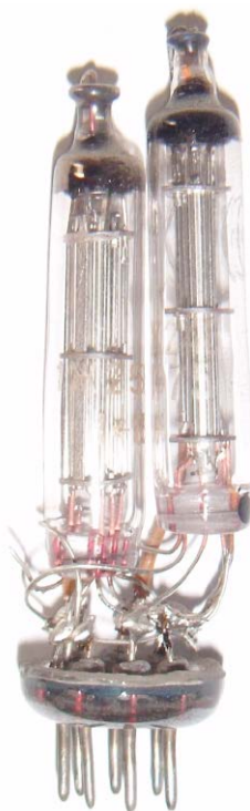
Fotografia 2. Zmontowany zamiennik lampy 1R5T
