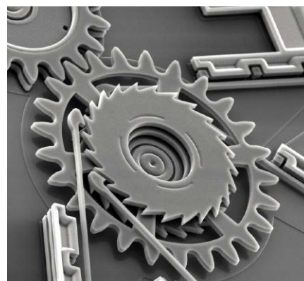
Fotografia 19. Układ wykonany w technologii MEMS pod mikroskopem
