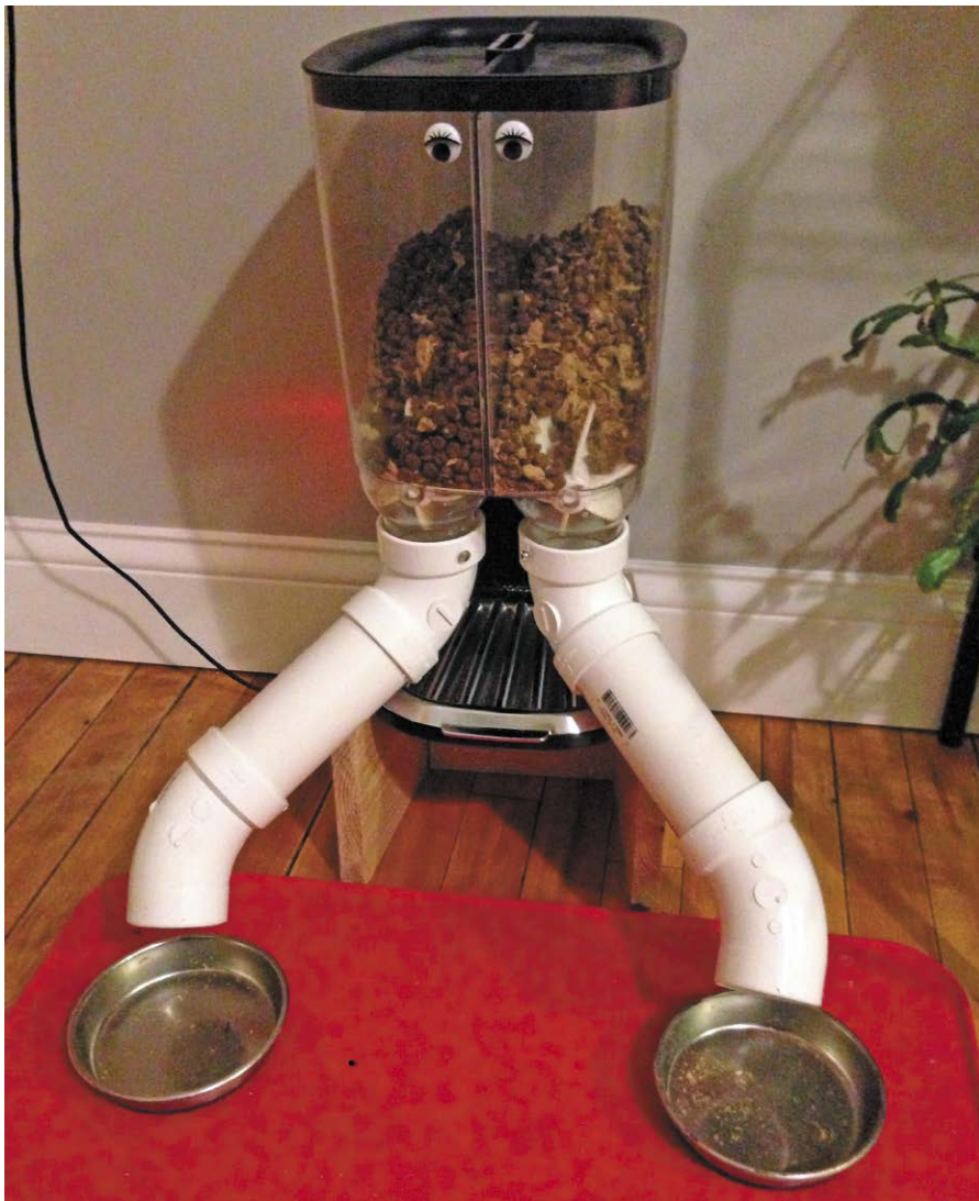
Fotografia 2. Gotowy, zautomatyzowany, podwójny dozownik
