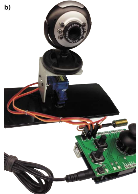
Fotografia 5. Sposób przyłączenia płytki ArduinoUno: a) widok złącza zasilania i serwomechanizmów, b) widok mechanizmu i sterownika
