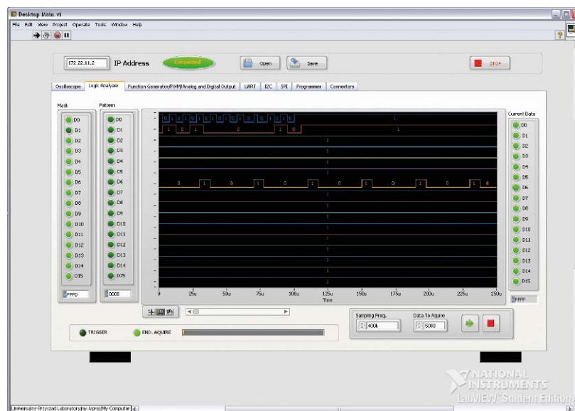
Rysunek 2 Okno analizatora stanów logicznych z widocznym na liniach D0 i D1, przebiegiem transmisji I 2 C, na linii D6 przebieg PWM
