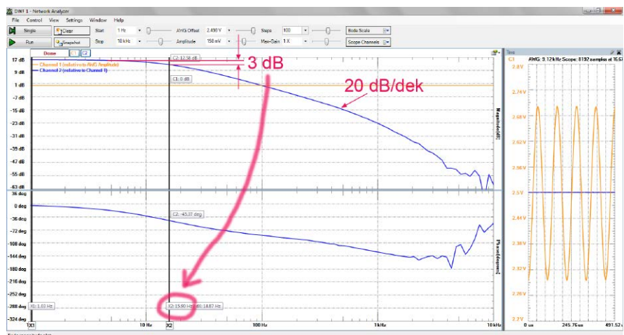
Rysunek 7. Pomiar pasma wzmacniacza tensometrycznego z wykorzystaniem symulatora tensometru
