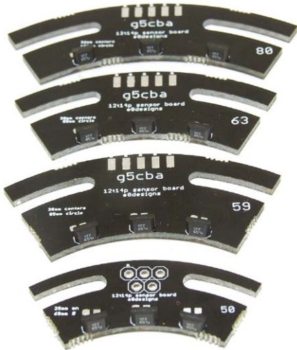
Fotografia 5. Płytki drukowane ze scalonymi czujnikami Halla
