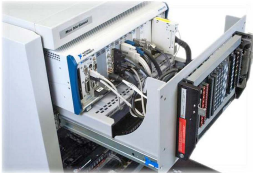
Rysunek 12. Przykładowy odbiornik interfejsu przyłączeniowego z obudową NI PXI
