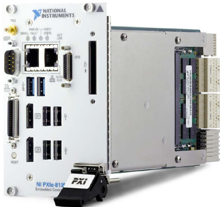
Rysunek 6. Stosując wbudowane kontrolery nie ma potrzeby użycia zewnętrznego PC – kompletny system zawiera się w jednej obudowie PXI
