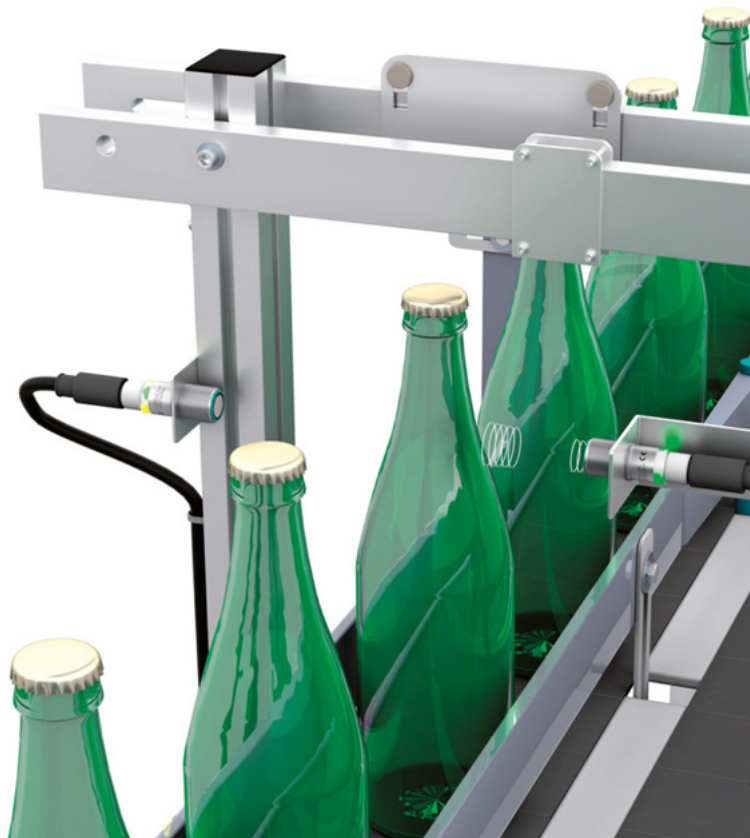
Fotografia 20. Bariera ultradźwiękowa; czujniki ultradźwiękowe stosowane do szybkich pomiarów niewielkich obiektów muszą pracować z sygnałami dużych częstotliwości, a więc też przy małych zasięgach
