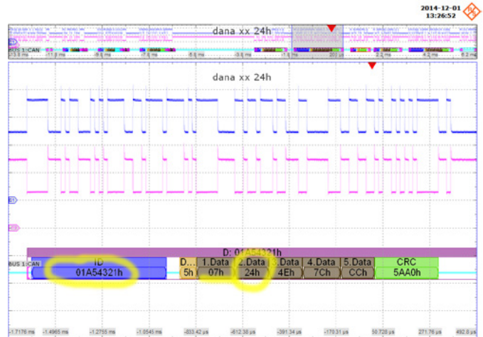
Rysunek 7. Oscylogram uzyskany po wyzwoleniu na ramce o identyfikatorze 01A54321h zawierającej daną 24h występującą na drugim bajcie pola danych
