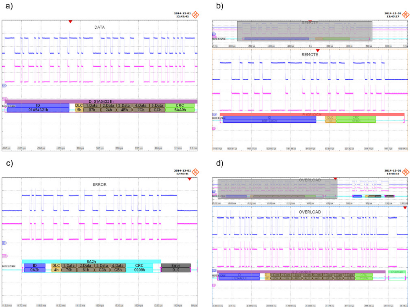
Rysunek 6. Przykładowe wyzwolenie na różnych typach ramek, a) ramka danych, b) ramka zdalna, c) ramka błędu, d) ramka przepiętowania
