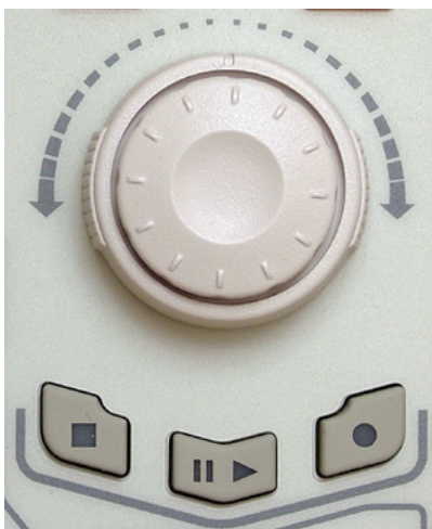
Fotografia 4. Elementy sterujące płyty czołowej oscyloskopu wykorzystywane do rejestracji i odtwarzania przebiegów
