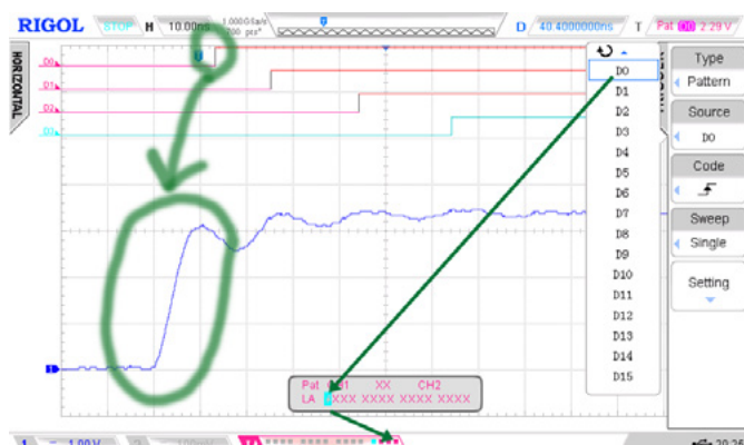
Rysunek 11. Jednoczesne wyświetlanie sygnałów cyfrowych i analogowych na ekranie oscyloskopu MSO2102A
