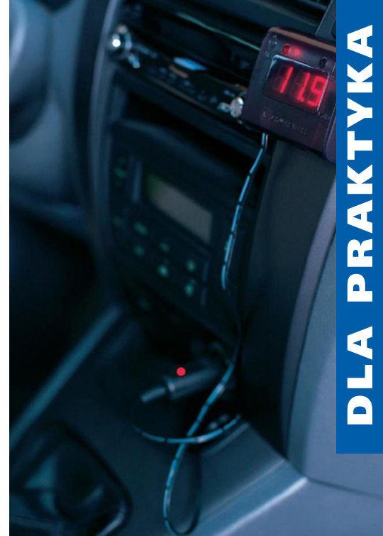
Fotografia 1. Wskaźnik napięcia akumulatora Navitec APM3 zainstalowany w samochodzie
