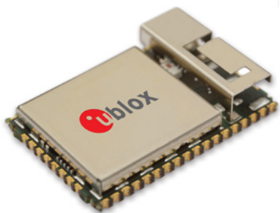
Fotografia 2. Moduł ODIN-W262, ze zintegrowaną anteną
