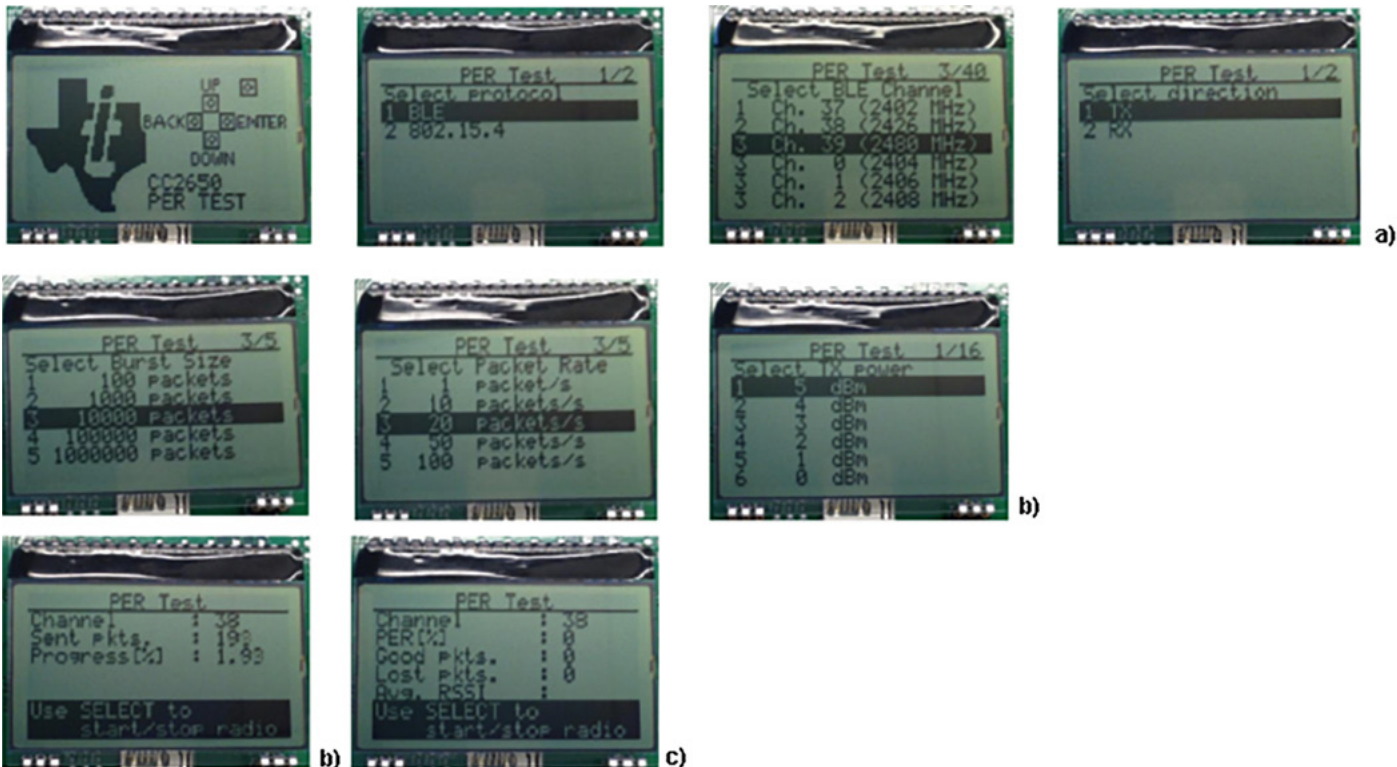
Fotografia 4. Aplikacja startowa. Konfiguracja CC2650DK a) nadajnik i odbiornik b) nadajnik c) odbiornik
