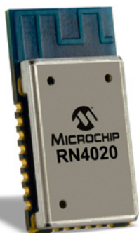
Fotografia 2. Inteligentny moduł Bluetooth LE typu RN4020 firmy Microchip
