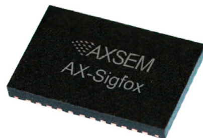
Fotografia 4. Układ AX-Sigfox firmy Axem dla sieci Sigfox
