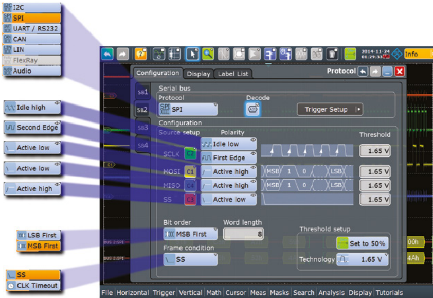
Rysunek 2. Zakładka z parametrami protokołu SPI
