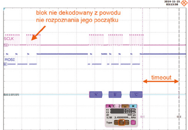
Rysunek 6. Transmisja via SPI bez linii SS - koniec bloku rozpoznawany na podstawie wykrycia przekroczenie timeoutu
