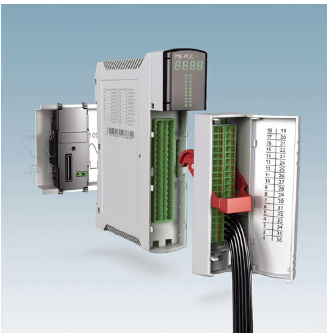
Fotografia 3. Obudowa ME PLC – nawet duże moduły można wymieniać ekspresowo
