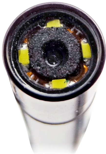
Fotografia 1. Głowica z kamerą i oświetlaczem zbudowanym z diod LED
