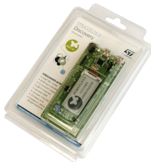
Fotografia 3. Zestaw 32L0538DISCOVERY z wyświetlaczem e-paper
