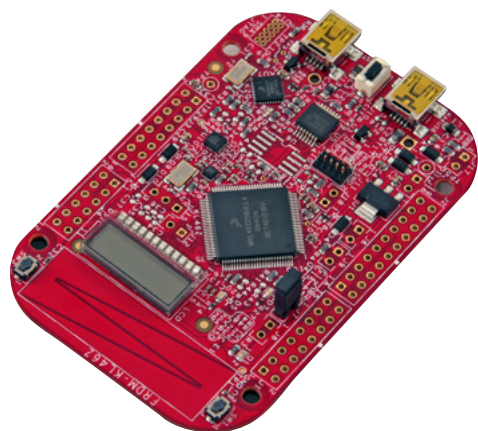
Fotografia 7. Wygląd zestawu FRDM-KL46Z z monochromatycznym wyświetlaczem LCD
