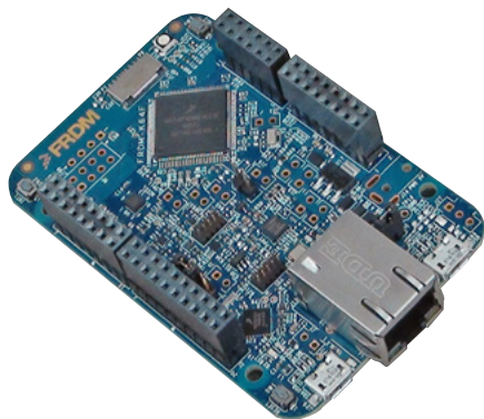
Fotografia 6. Wygląd zestawu FRDM-K64F z interfejsem Ethernet
