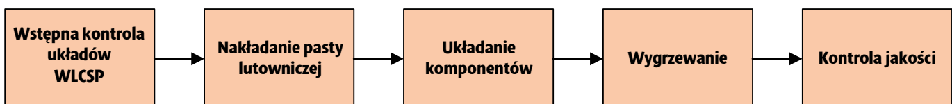
Rysunek 7. Typowy proces montażu płytki drukowanej
